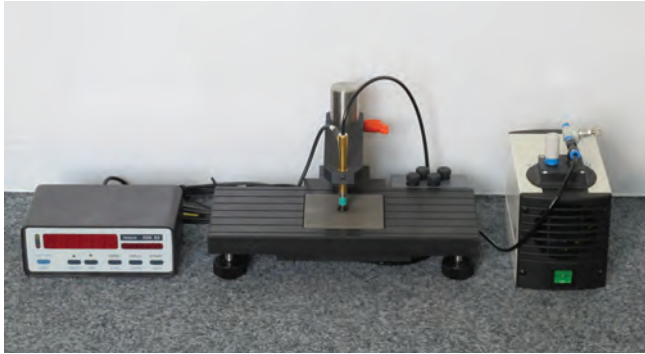
Obr. 1: Standardní stojánek s keramickým pracovním stolem a kalenou přípravovou plochou. Měřicí dotek snímače je odstavován vakuem
