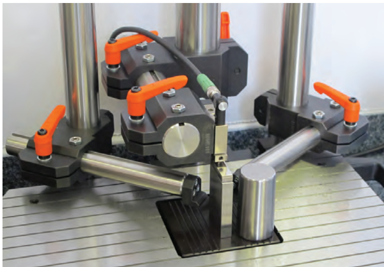
Obr. 3: Detail měřicího místa stojánek s volně stavitelným ramenem i bočními opěrkami
