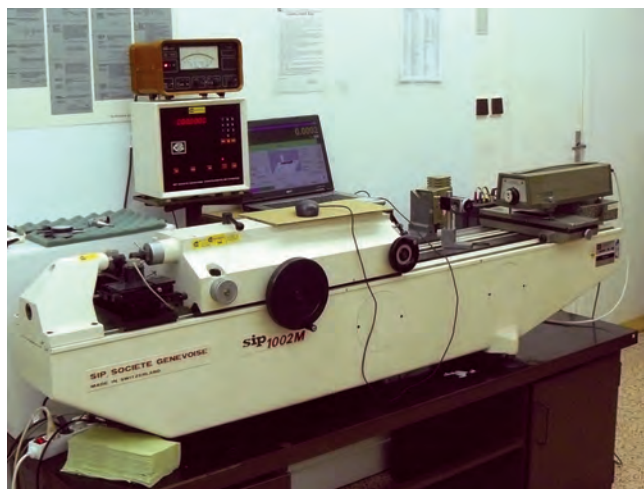
Obr. 1: Digitální délkoměr SIP 1002M při měření v součinnosti s laserinterferometrem Hewlett Packard (zdroj – autor)
