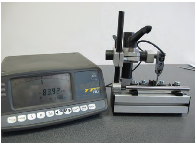
Obr. 2: Univerzální – zakázkově koncipovaný stojánek maximálně využívající prvky z uhlíkového kompozitu s minimální délkovou teplotní roztažností
