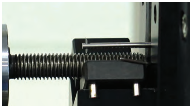
Obr. 8: Měření úplného profilu závitů snímacím hrotem, které doplňuje měření na délkoměrech (zdroj – IAC)
