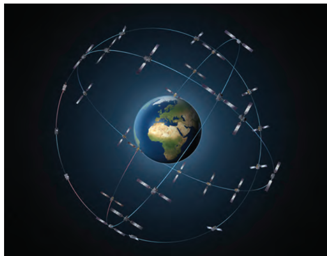
Obr. 1: Systém GALILEO využívá 30 družic umístěných na třech kruhových oběžných drahách s výškou 23 222 km a inklinací 56°. Na každé dráze je rozmístěno deset družic. Roviny jednotlivých oběžných drah jsou rozloženy kolem rovníku po 120°. Oběžná doba družic je zhruba 14 h 4 min. Foto: ESA
